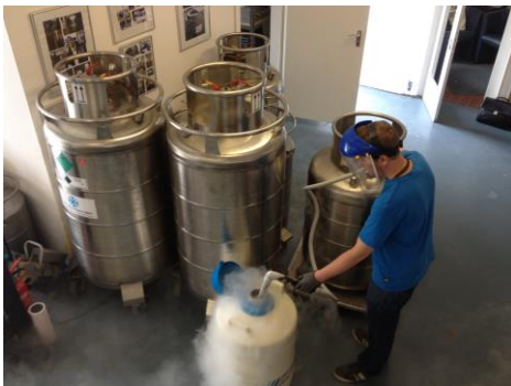
Abfüllprozess mit Druckaufbaufunktion
