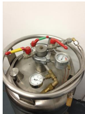
Abfüllprozess mit Druckaufbaufunktion
